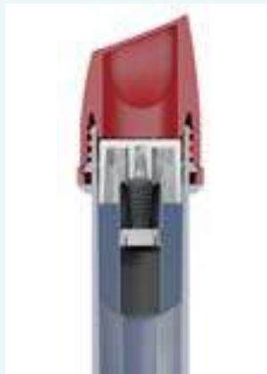
Abb.49 Beispiel einer aufwendigen Sterilverpackung im Längsschnitt (Paltop)
