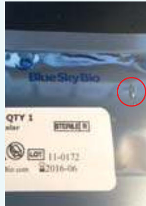
Abb.50 Durch scharfkantige Abdeckschraube verletzte Sterilverpackung (BlueSkyBio)
